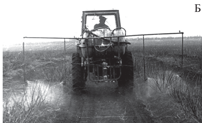
Рис. 5. Приспособление к опрыскивателю ОН-400 для обработки ягодников почвенными гербицидами конструкции В.В. Воскобойникова: А – схема, Б – обработка смородины почвенными гербицидами. Совхоз «Северский Донец», 1980 г.
