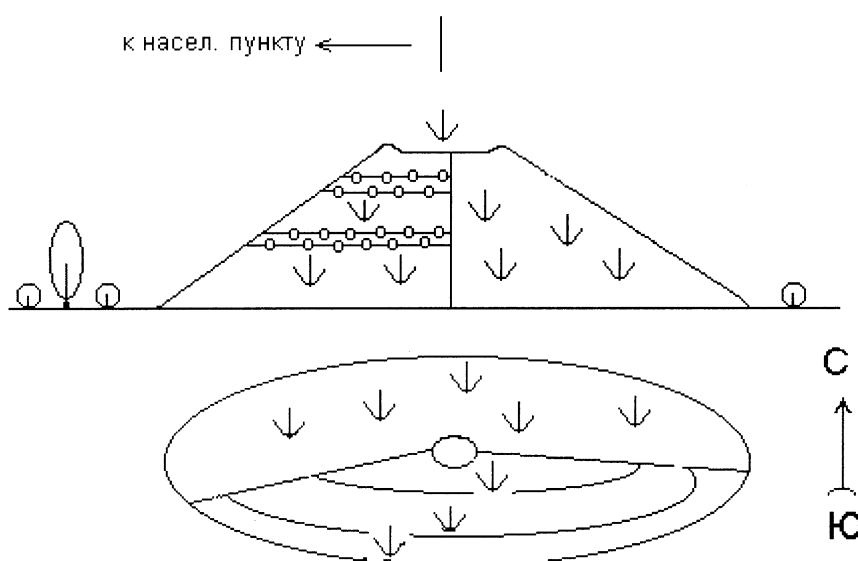
Рис. 6. Схема озеленения отвалов, лишенных растительности, расположенных на хозяйственно ценных землях, граничащих с населенными пунктами.
