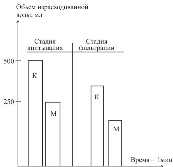
Рис. 3. Зависимость расхода воды входного потока от гранулометрического состава образца породы. К – крупная фракция. М – мелкая фракция.
